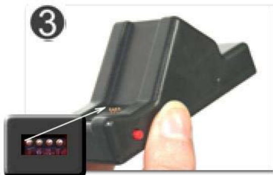
Zorg dat er goed contact wordt gemaakt met de contactpuntjes
